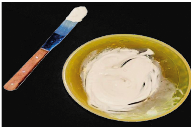
Figura 34. Preparación del yeso para el vaciado.
